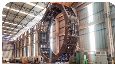
Carcaça do Estator - Hidroelétrico
