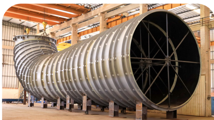
Tubo de Sucção - Hidrelétrica
