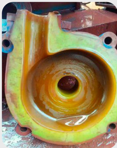
Revestimento após 207 dias de operação
