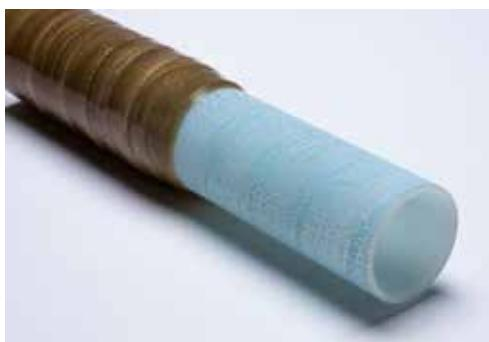
O PVDF HV Liner da AGRU é uma alternativa económica aos tubos laminados tradicionais. O tubo PVDF com superfície tratada apresenta uma estrutura superficial tridimensional, que permite uma ligação otimizada ao tubo PRFV. Os sistemas de tubagem estão disponíveis nos materiais PVDF, PVDF-FLEX e PVDF-el. Podem ser executados tubos nas dimensões 20 – 400 mm.
