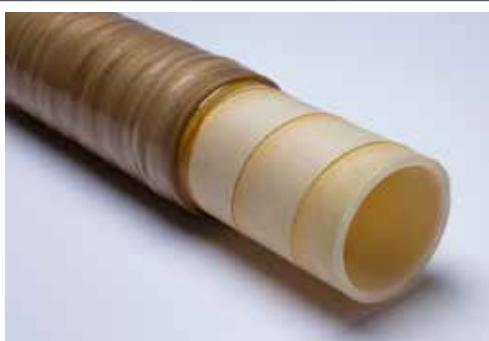
Os sistemas de tubagem laminados estão disponíveis nos materiais ECTFE, FEP e PFA. As malhas de fibra de vidro AGRU GGS são o produto padrão para aplicações industriais tradicionais. O sistema de laminação é a norma para materiais com elevado ponto de fusão PFA e FEP.
