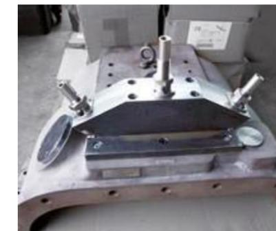
Disposição dos sensores na tampa do mancal e na roda fônica.
