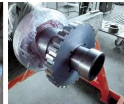
Montagem de uma nova roda fônica.
