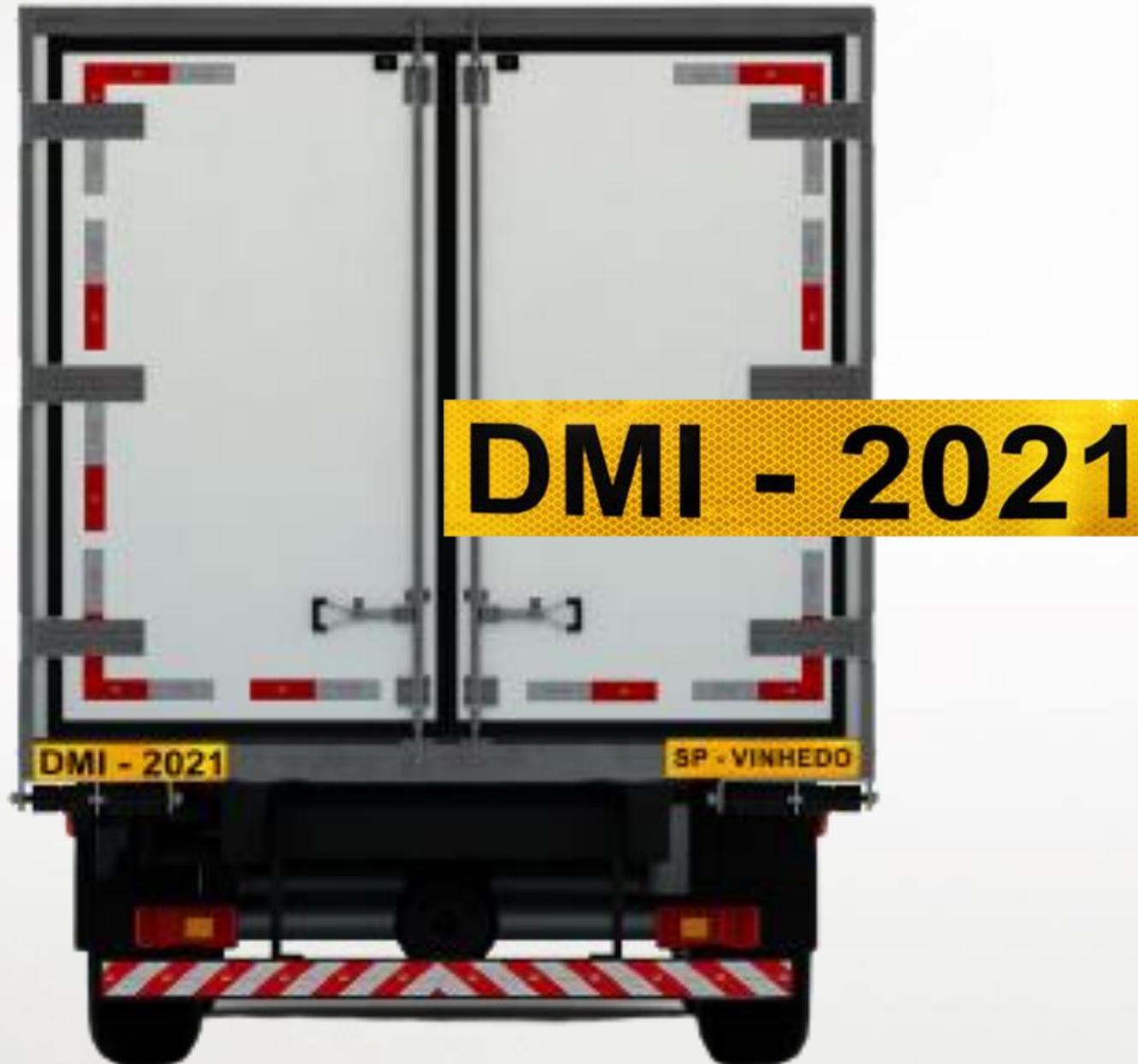
A Faixa Ouro é utilizada pelos motoristas para garantir que a placa e a cidade de origem do veículo fique visível em locais com escassez de iluminação. Essa faixa é aplicada na traseira do caminhão, na parte inferior.
