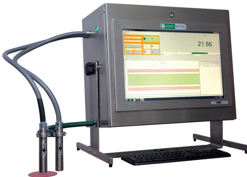
Conveniência da interface touch screen combinada com dados de medição de espessura em tempo real.
